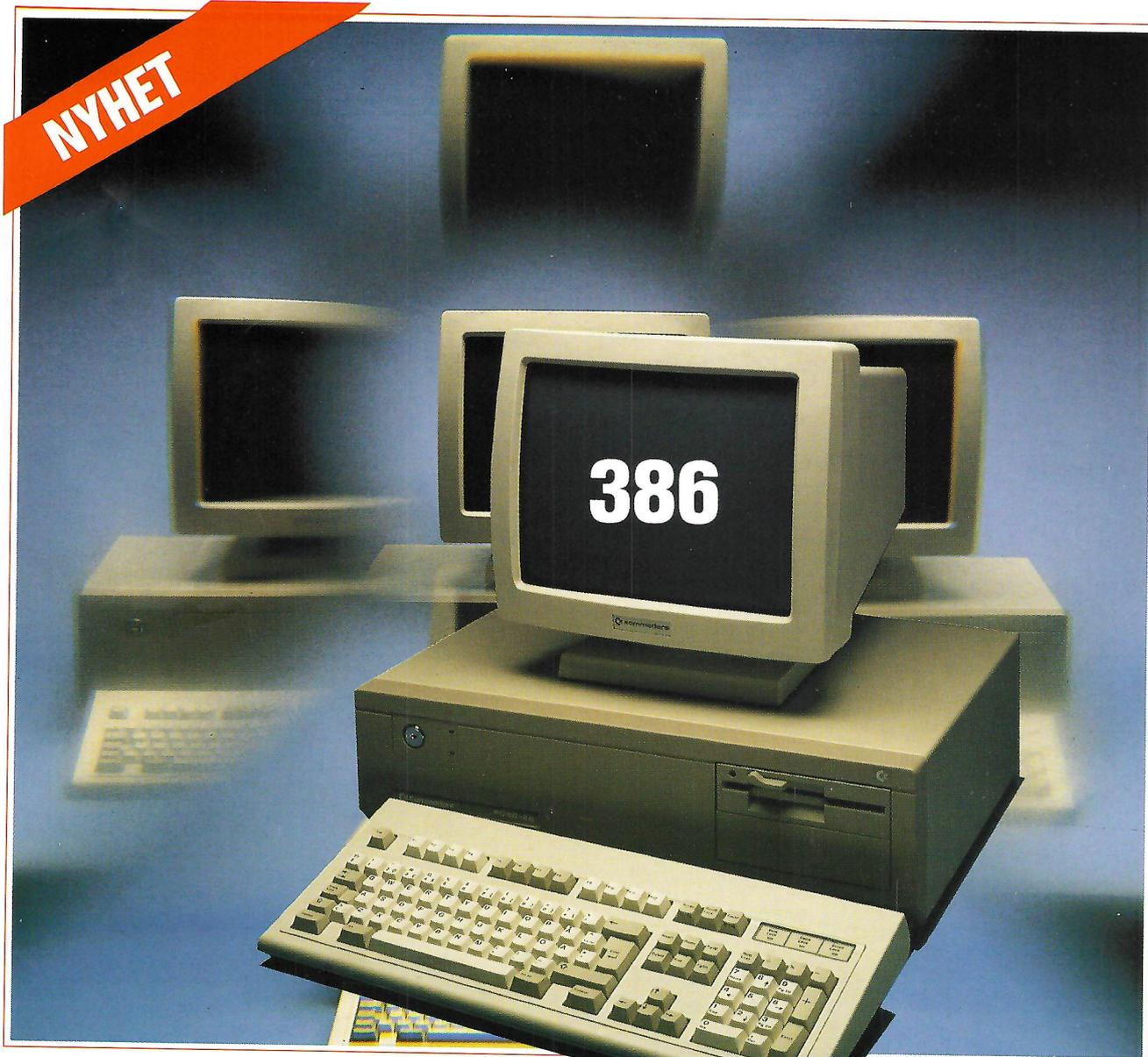
Commodore PC 60 är vår mest avancerade persondator. Den är uppbyggd kring Intels 32-bitars processor 80386 och arbetar med en klockfrekvens på 16 MHz, dvs 10 gånger snabbare än en vanlig PC! Arbetsminnet är på 2,5 MB RAM och diskettkapaciteten på 1,2 MB.
